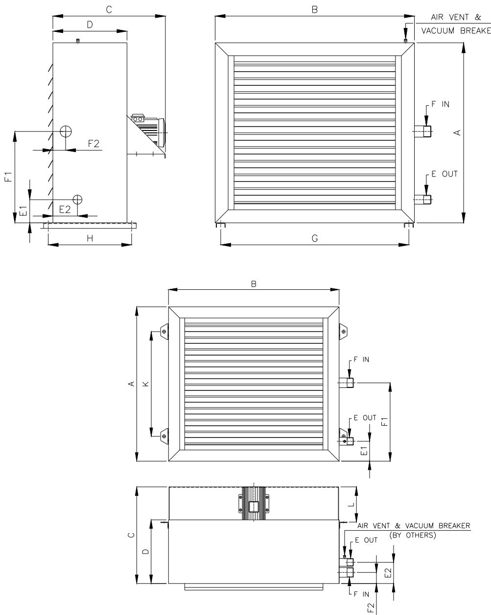
FIGURE 2. STANDARD STEAM UNIT HEATER
